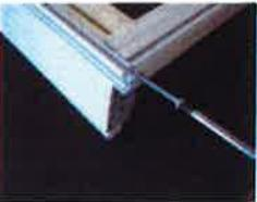
5 – Solidariser l'ensemble par serrage des vis inox R.
