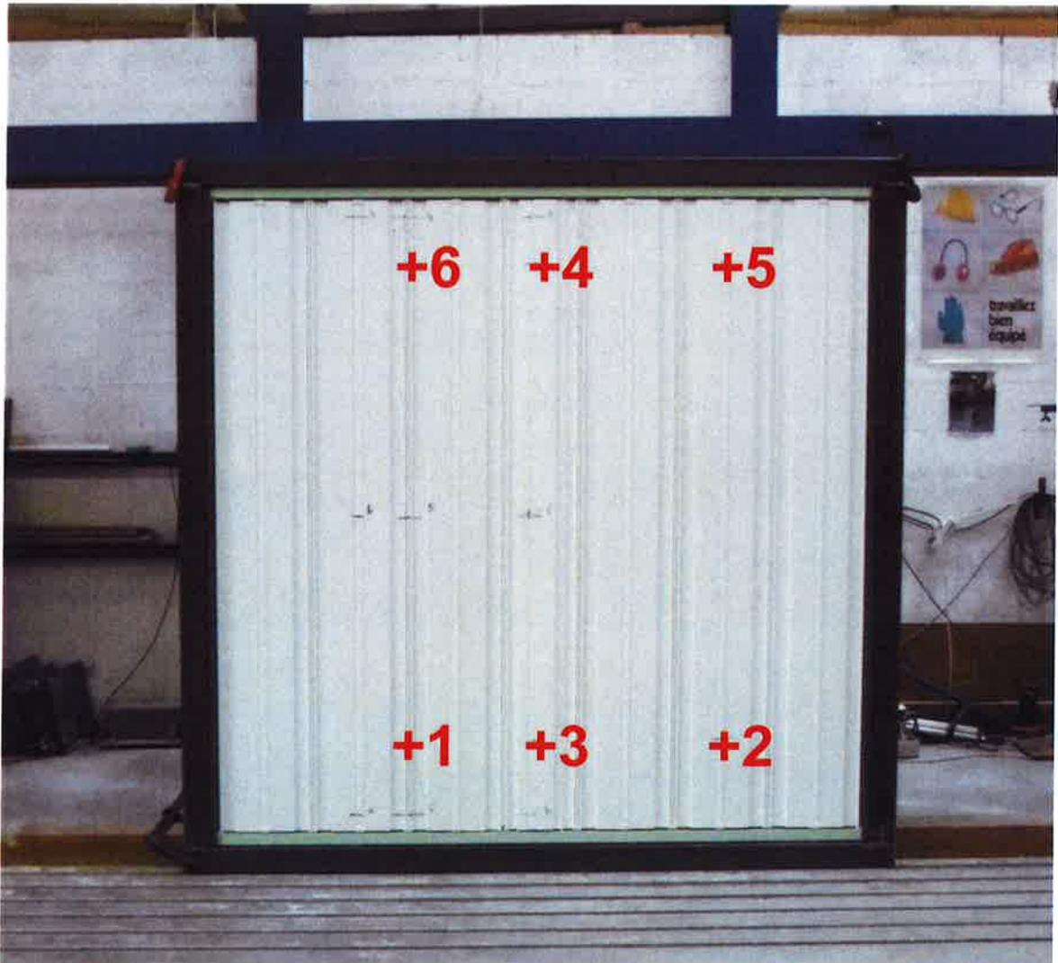
**Observation avant essais :** Pour la réalisation des essais dynamique à hauteur de chaque point d'impacts, une cale a été mise en place afin de simuler une pose en applique.
